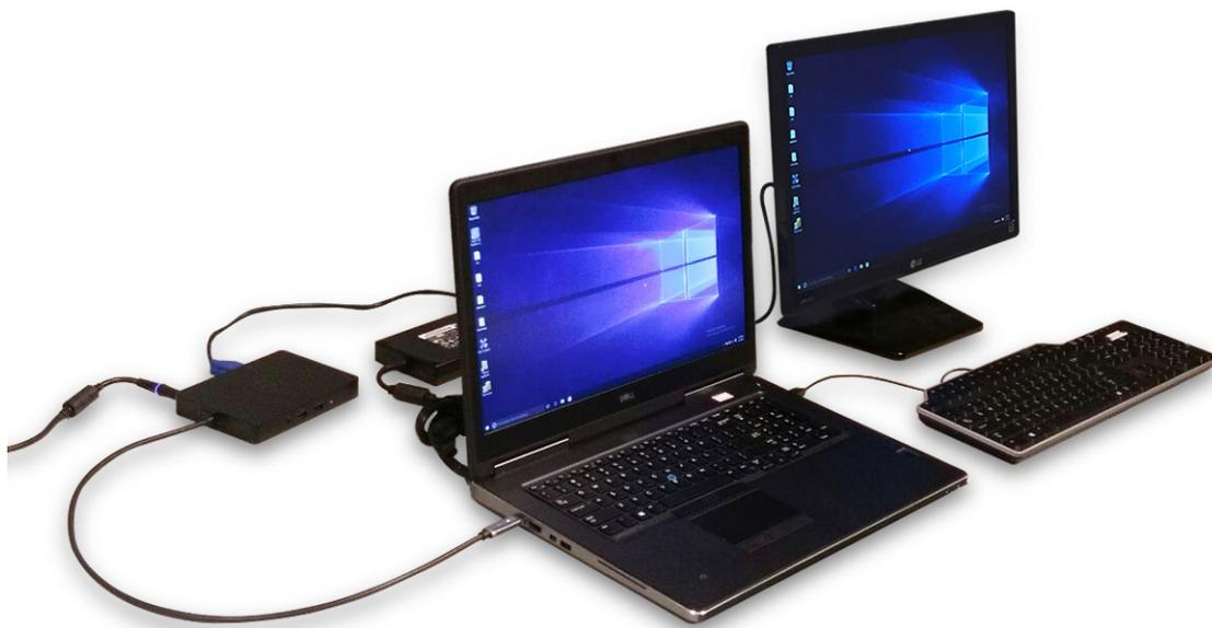
**REMARQUE :** Les ordinateurs qui nécessitent plus de 130 W d'entrée d'alimentation doivent également être connectés à leur propre adaptateur pour se recharger et pour fonctionner à pleines performances.
